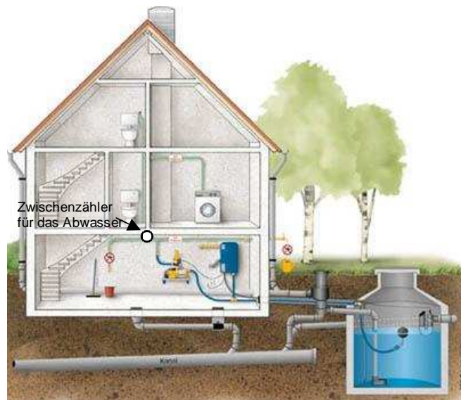
Skizze: Einbauort des Zwischenzählers vor den Verbrauchern
