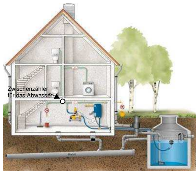
Skizze: Einbauort des Zwischenzählers vor den Verbrauchern
